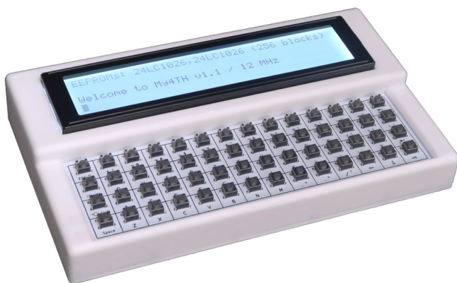
Abbildung 5: Das Forth Deck mini. Ein kleiner, eigenständiger Forth-Computer
